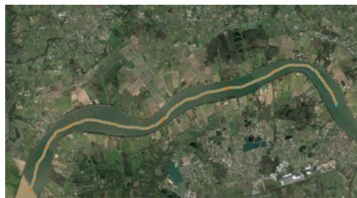
Definición de nodos fluviales dentro de una sección
